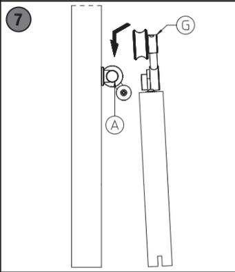
**7** \*Inclinare leggermente l'anta ed appoggiare le ruote del carrello (G) sopra il binario (A). N.B.: Fare molta attenzione nel movimentare l'anta.
