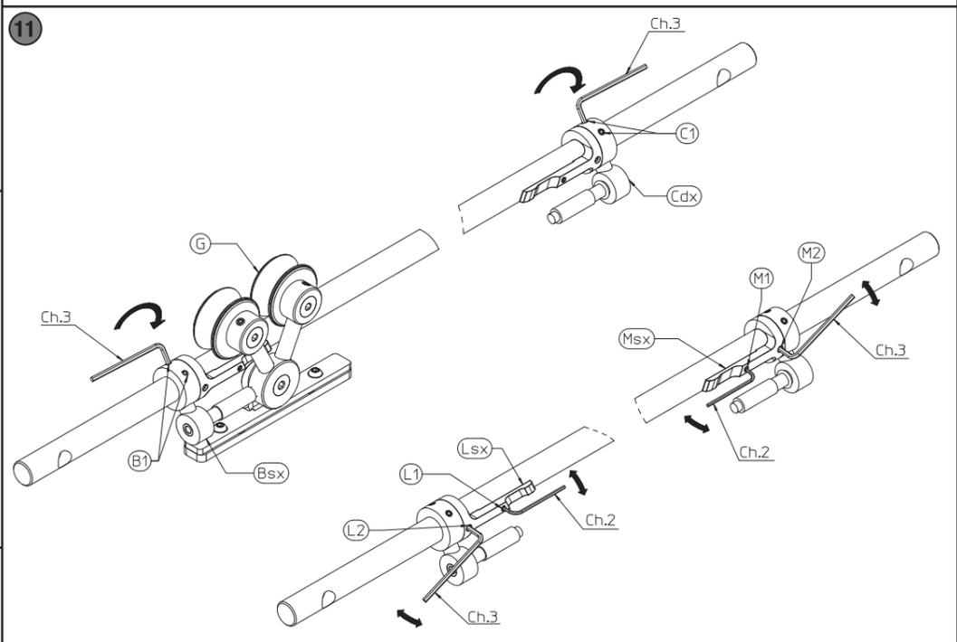
**11** \*Regolare i freni (Bsx e Cdx) in asse con il carrello (G). Fissare i freni (Bsx e Cdx) avvitando i grani (B1 e C1), mediante chiave esagonale CH3. Fissare i blocchi (Lsx e Mdx), avvitando i grani (L2 e M2), mediante chiave esagonale CH3. Regolare forza di bloccaggio agendo sui grani (L1 e M1), mediante chiave esagonale CH2.
