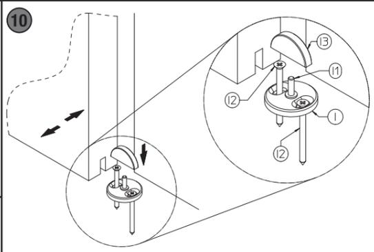
**10** \*Posizionare l'anta a piombo e fissare la guida inferiore (I) con le viti (I2). Inserire sul perno della guida (I1) la lunetta (I3).
